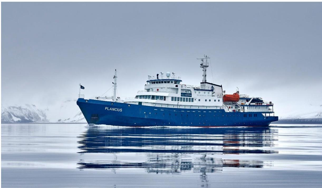
M/v Plancius wurde 1976 als ozeanographisches Forschungsschiff für die königliche Niederländische Marine gebaut und erhielt den Namen "Hr. Ms. Tydeman". Das Schiff wurde 2009 komplett zu einem Passagierschiff umgebaut und entspricht den neuesten SOLAS-Bestimmungen (Safety Of Life At Sea). M/v Plancius ist 89m lang, 14,5m breit und hat einen maximalen Tiefgang von 5m, Eisklasse 1D, 10,5 Knoten durchschnittliche Reisegeschwindigkeit und hat 3 Diesel-Elektro-Motoren.
